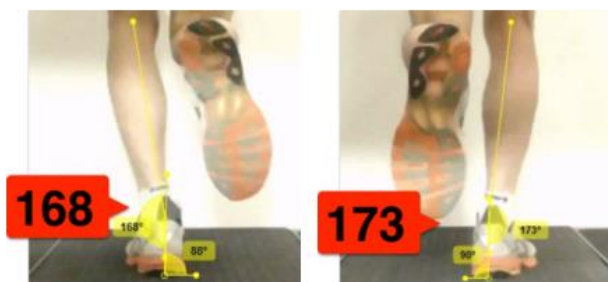
Рисунок 3 – Положение стопы на беговой дорожке при использовании «жесткой темповой» обуви без стелек «ОСС Инсолекс» (в градусах)
